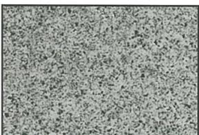
微粒子高密度グラファイト材EDM-1はPOCO製品では最もお手頃な等方性高密度材で粒子はグリーンサイズのグラファイトを使用しています。優れた放電特性を持ち低コストで、納得いただける電極磨耗度、速度、面仕上げをご提供できるグレードです。電極加工性も良く、大型電極に最適です。
